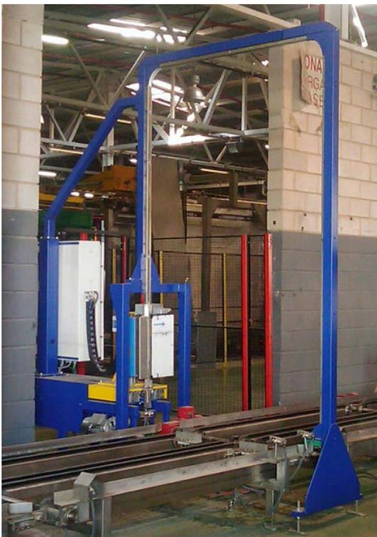
Flejadora automática vertical **con cabezal VK-20**, para el flejado vertical de cargas paletizadas.
