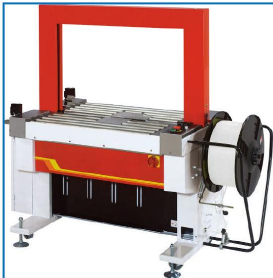
Flejadora automática con rodillos para el flejado vertical de cargas o bultos.
